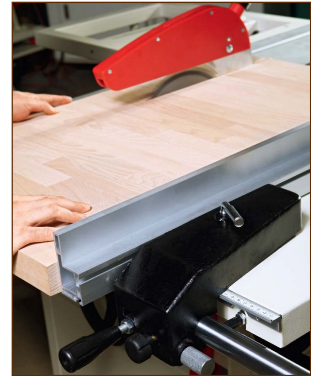
Модель JTS-600XL Параллельный упор перемещается по собственной направляющей и фиксируется при помощи специального рычага
