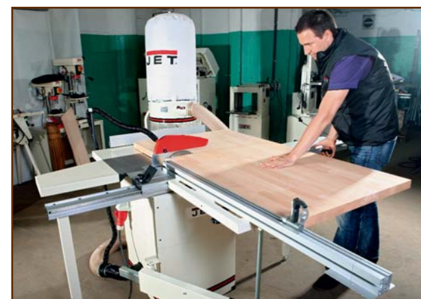
Модель JTS-600XL Расширитель подвижного стола с телескопической опорой превращает пилу JTS-600XL в небольшой форматно-раскроечный станок для производства мебели
