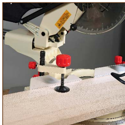
Модели JMS-8L, JMS-10, JSMS-8L, JSMS-10L, JMS-10S Для фиксации заготовки на пильном столе удобно воспользоваться винтовым прижимом
