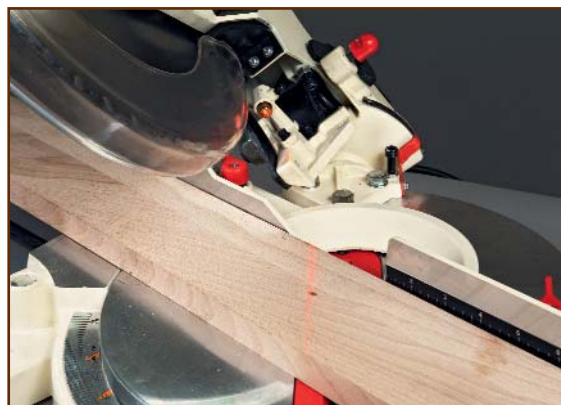
Модели JMS-8L, JMS-10, JSMS-8L и JSMS-10L Лазерный луч указывает место предстоящего реза, что позволяет избежать дорогостоящих ошибок, вызванных неверной установкой заготовок
