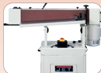
Стол, установленный для работы в наклонном положении: этим достигается лучшее качество шлифования и наиболее полное использование шлифовальной ленты
