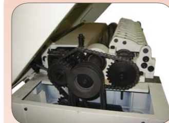
Привод движения заготовки слева (верхняя часть)
