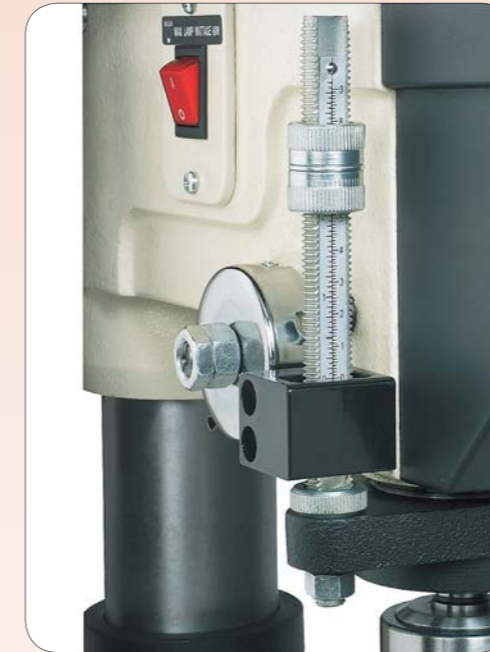
Регулируемый упор глубины сверления
