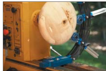
MultiRest в положении поддержки с одной стороны
