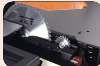
Расположение основного и подрезного пильного диска
