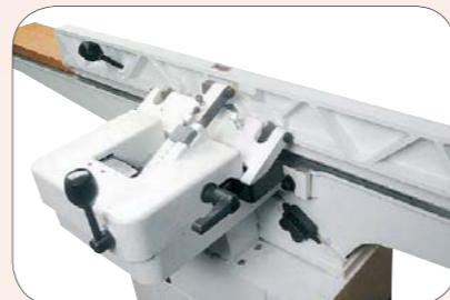
Ручки регулирования наклона и блок перемещения упора по ширине плоскости стола
