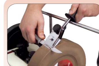
Артикул 708019 Приспособление для ножей. Применяется для заточки ножей с лезвием до 10 см
