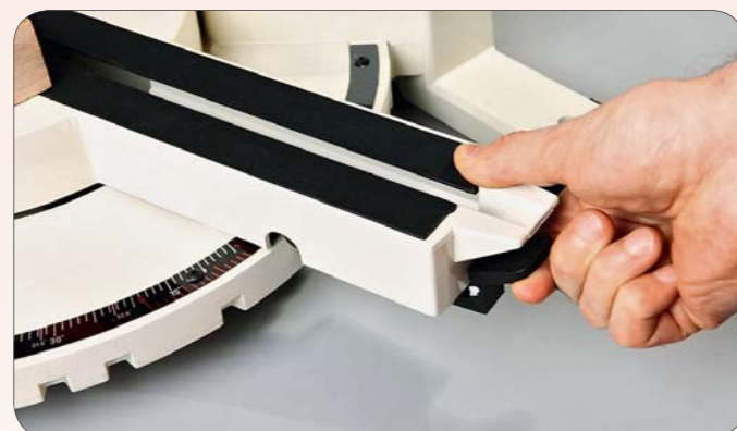
Фиксацию и разблокировку поворотного стола производят рычагом, расположенным под центральным удлинителем, это более эргономичный механизм, чем у пил с винтовыми зажимами сверху стола
