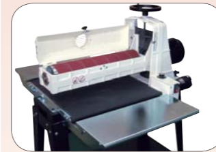
Большое колесо регулирует высоту положения барабана над конвейерной поверхностью и, следовательно, глубину съема поверхности
