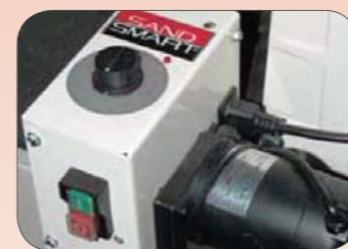
Переключатели вращения барабана (снизу слева), отдельный мотор транспортера (справа) и контроль скорости транспортной ленты (сверху слева)
