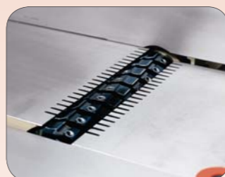
Расположение ножевого вала «helical»
