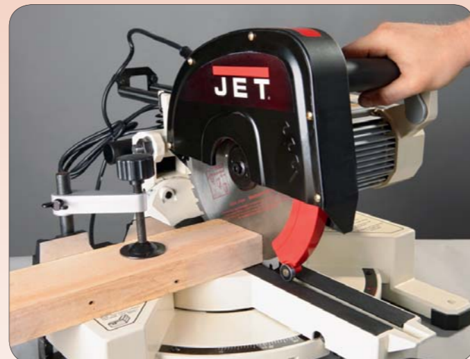
Двигатель пилы JMS-10S оснащен эффективным тормозом выбега. После выключения мотора его вал будет заторможен и остановится менее чем за 10 секунд. Это повышает удобство и безопасность работы на станке
