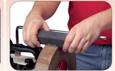
Артикул 708017* Брусок для очистки шлифовального круга. Два вида зернистости для преобразования зерна шлифовального круга и исправления поверхности
