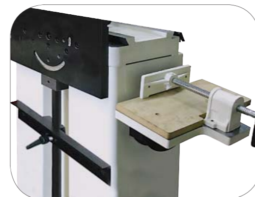
С помощью нижней опоры для заготовок можно делать углубления для дверных замков, а также другие деревянные соединения
