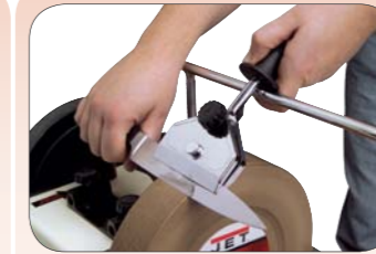
Артикул 708021 Приспособление для шлифования по длине. Применяется для доводки тонких и длинных ножей, у которых длина лезвия больше 10 см
