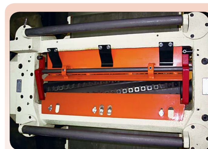
Строгальный вал «helical» в станке
