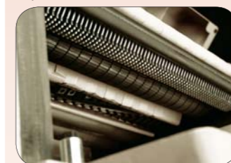
Секционный подающий вал движения заготовки
