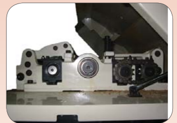
Привод движения заготовки справа (верхняя часть)
