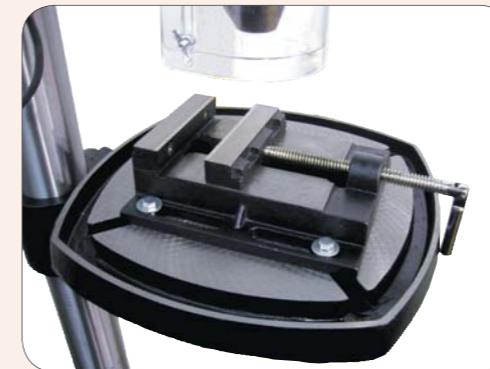
Пример установки тисков на столе
