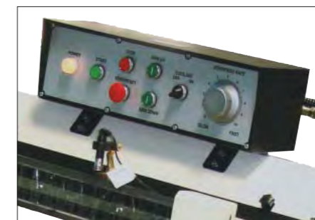
Пульт управления и световой указатель линии распила
