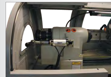
Управляемый пневматический цанговый зажим
