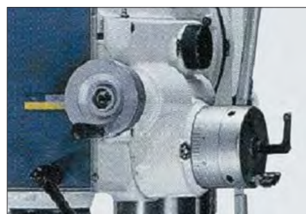
Узел автоматической подачи
