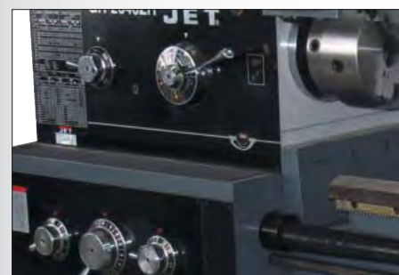
Полноразмерная коробка подач позволяет нарезать различную резьбу без замены шестерен
