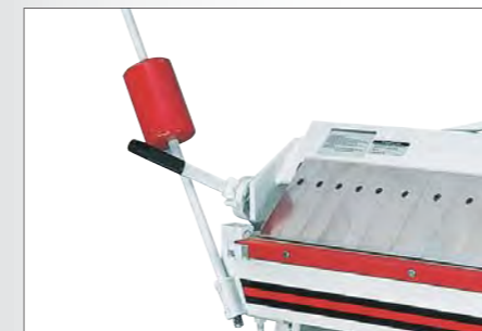
Регулируемый балансир балки BP-1650N
