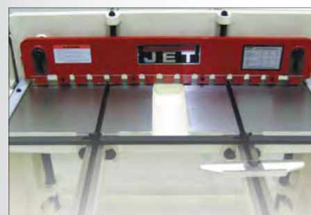
Дополнительные опоры листа спереди
