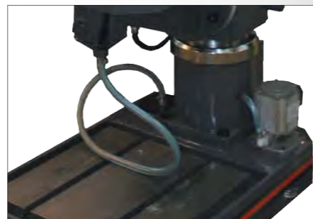
Система подвода СОЖ, встроенная в основание
