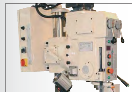
Органы управления станком, вид слева
