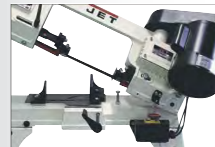
Концевой упор и выключатель (HVBS-56M)
