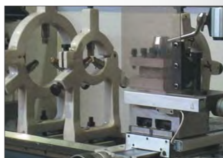
4-х позиционный резцедержатель с фиксатором, стандартные подвижный и неподвижный люнеты
