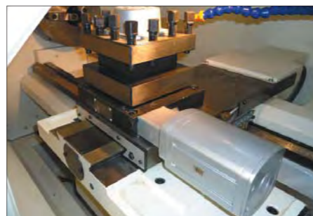
4-х позиционный резцедержатель с автоматической сменой инструмента
