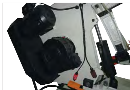
Привод и гидроцилиндр с концевыми выключателями
