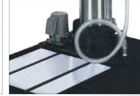
Система подвода СОЖ, встроенная в основание
