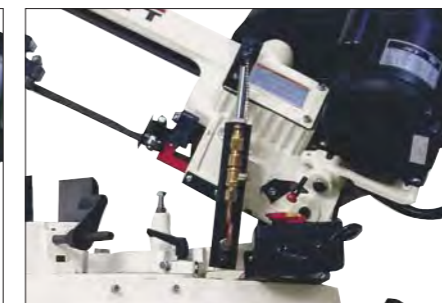
Гидроцилиндр опускания пильной рамы и концевой выключатель (MBS-56CS)
