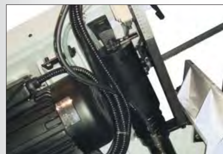
Гидроцилиндр подъема рамы с регулируемым концевым выключателем
