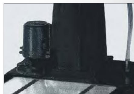
Система подвода СОЖ, встроена в основание
