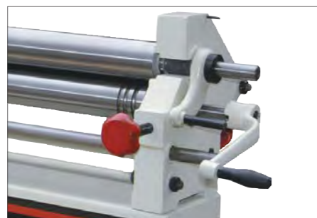
Приводная рукоятка и замок извлечения трубы
