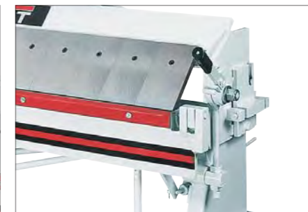
Эксцентриковая рукоятка и механизм регулирования зазора BP-1650N
