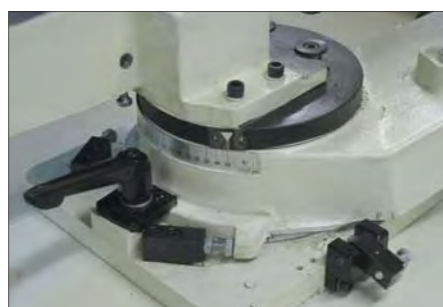
Регулируемые упоры углов положения пильной рамы MBS-712
