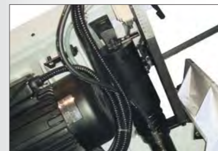
Гидроцилиндр подъема рамы с регулируемым концевым выключателем
