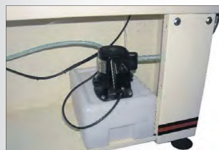
Бак системы подвода СОЖ для HVBS-712K
