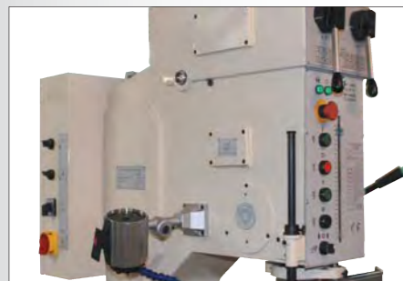
Органы управления станком, вид слева
