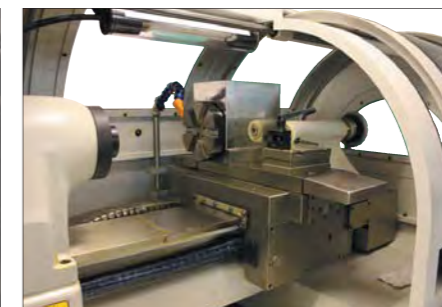
6-позиционная револьверная голова и однопозиционный резцедержатель
