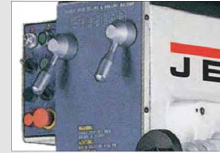
Пульт управления и рукоятки переключения скоростей
