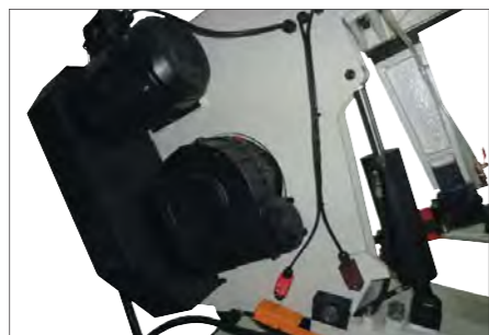
Привод и гидроцилиндр с концевыми выключателями
