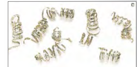
Свободно намотанная (витая) стружка - идеальные условия резания
