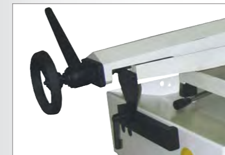
Быстрозажимная эксцентриковая рукоятка подвижной губки тисков
