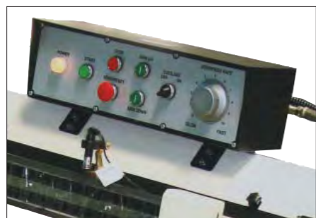
Пульт управления и световой указатель линии распила
