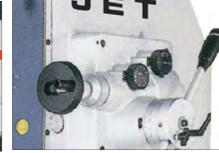
Узел автоматической подачи
