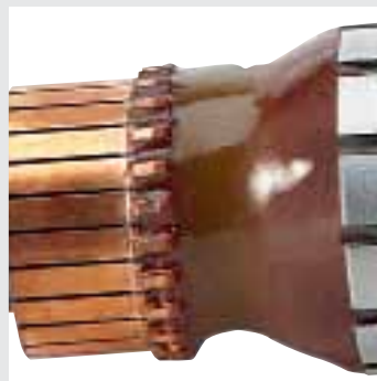
Бронированная обмотка на статоре (со стороны коллектора).
