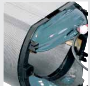
Обмотка поля с эпоксидным слоем
