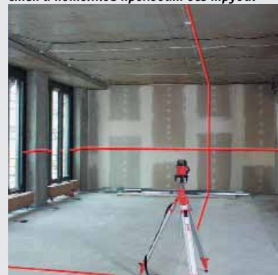
Мультилинейный лазер ALC 514 для самых высоких требований. Постоянно видимая лазерная линия симулирует с помощью широкоугольного выхода на 180° будущее пространственное распределение.
