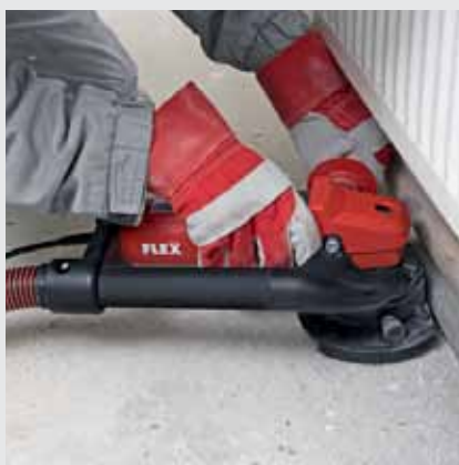
Даже при открытом щеточном сегменте отвод пыли обеспечивается полностью
