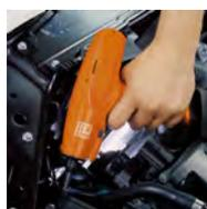
Двухступенчатые винтоверты позволяют экономить время при креплении хомутиков для шлангов и выполнении тонких резьбовых соединений. При этом вторая скорость вращения регулируется индивидуально.
