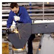
Модуль расширения для расшлифовки радиусов на различных заготовках, например трубах круглого и прямоугольного сечения, плоских материалах и профилях.
