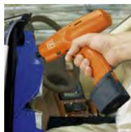
Не требующий технического обслуживания бесщеточный ЕС-двигатель выпускается серийно, благодаря чему повышается КПД и увеличивается срок службы аккумулятора.
