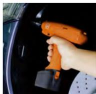
Винтоверты пистолетной формы оснащены устройством плавного пуска. В сочетании с патентованной муфтой оно позволяет достигать необычайно малых допусков по моменту затяжки.
