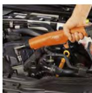
Угловая компоновка позволяет выполнять соединения и в труднодоступных местах. Угловую головку можно дополнительно поворачивать под углом  $\pm 180^\circ$ .
