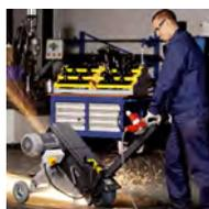
Высокоэффективное шлифование и зачистка сварных швов на полу.
