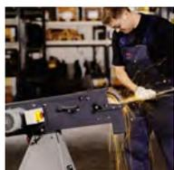
Производительный ленточно-шлифовальный станок в исполнении с одной или двумя частотами вращения – база модульной серии GX.
