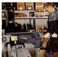
Высокопроизводительные ленточно-шлифовальные станки различной ширины (75 или 150 мм) с одной или двумя частотами вращения на выбор.
