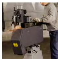
Автоматическое продольное шлифование плоских материалов, профилей и труб прямоугольного сечения.
