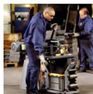
Точное внутреннее шлифование труб и профилей Ø до 150 мм.
