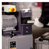
Для эффективного удаления заусенцев и полирования заготовок из обычной и высококачественной стали, чугуна и цветных металлов.
