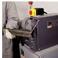
Независимое дополнение к серии GX для удаления заусенцев с заготовок из обычной и высококачественной стали с помощью проволочных щеток. В дополнительной комплектации с опорной стойкой.
